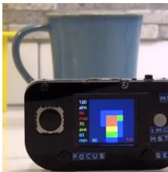
**Gambar 1.5.** Hasil display sensor suhu array dengan resolusi 8x8 piksel.
