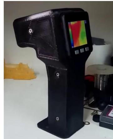
**Gambar 2.16.** Purwarupa tahap akhir dengan kemasan yang hampir mirip dengan kamera termal yang dijual dipasaran
